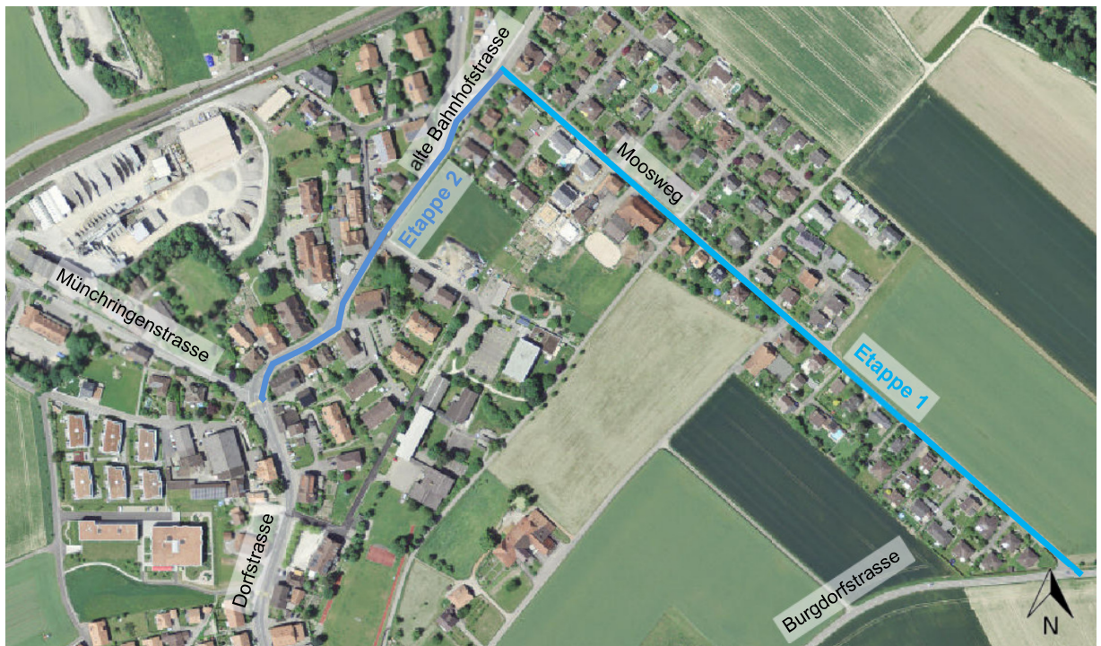
Abbildung 3: Orthophoto mit dem schematisch dargestellten Sanierungsprojekt der Wasserleitung, Etappe 1 und 2 (blau)
