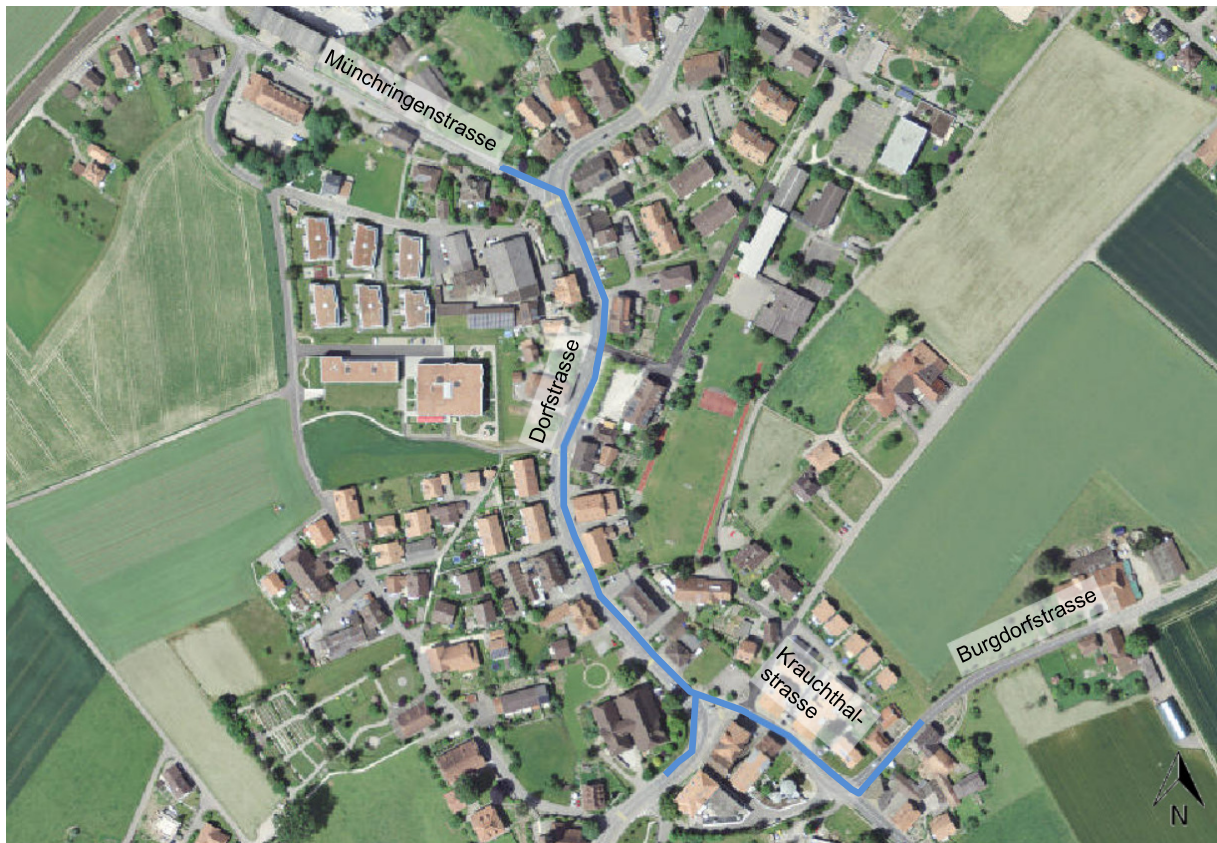
Abbildung 5: Orthophoto mit dem schematisch dargestellten Wasserleitungsprojekt, Kreisel Münchringenstrasse bis Burgdorfstrasse (blau)
